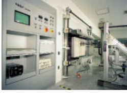
Test rig EN 1822-4
